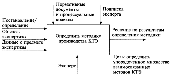
Рис. 2.2. IDEF0-диаграмма процесса определения методики производства КТЭ
