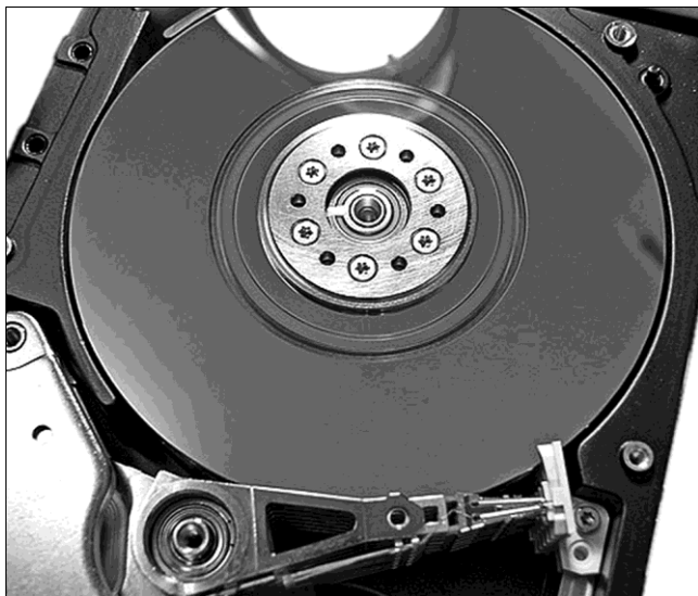
Рис. 4.1. Разрушение магнитного слоя — запил пластины вблизи шпинделя
