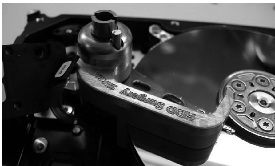
Рис. 7.12. Съемник установлен на БМГ
