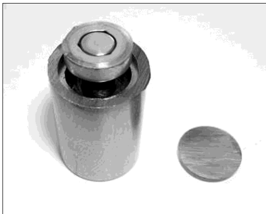
Рис. 7.14. Стакан, вал, втулка и стопорная шайба
