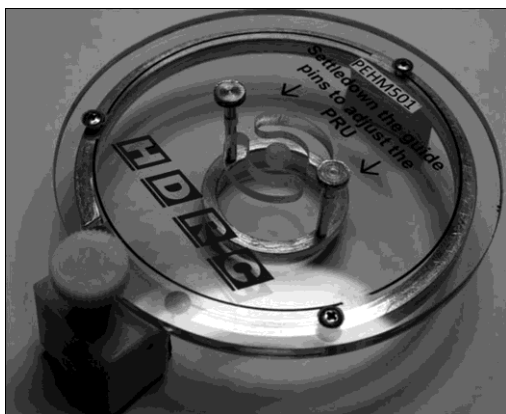
Рис. 7.16. Фиксатор-съемник пакета пластин
