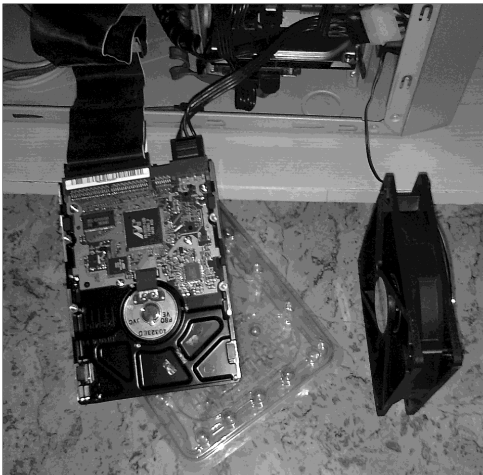
Рис. 7.20. В процессе считывания диск нужно охлаждать
