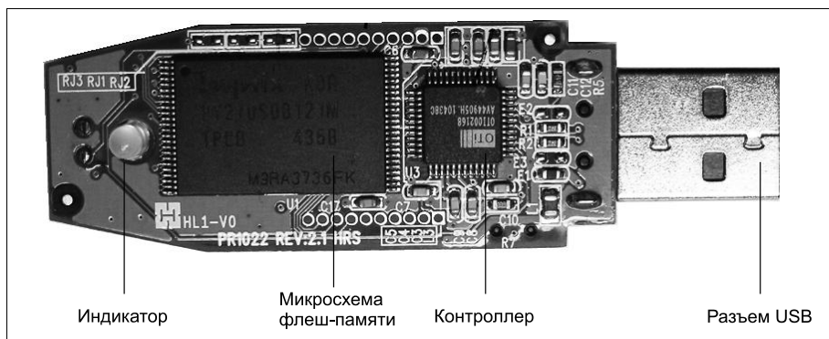
Рис. 9.1. Внутреннее устройство флеш-диска USB
