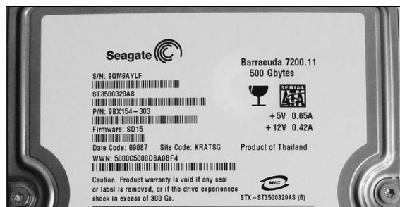
Рис. 7.6. Обозначения на этикетке винчестера
