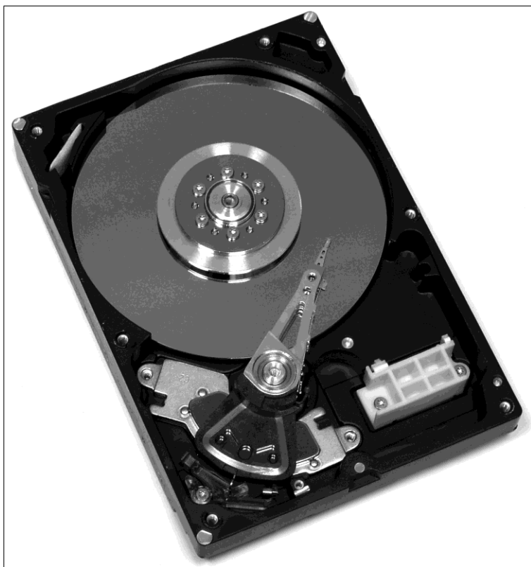
Рис. 7.1. Гермоблок со снятой крышкой
