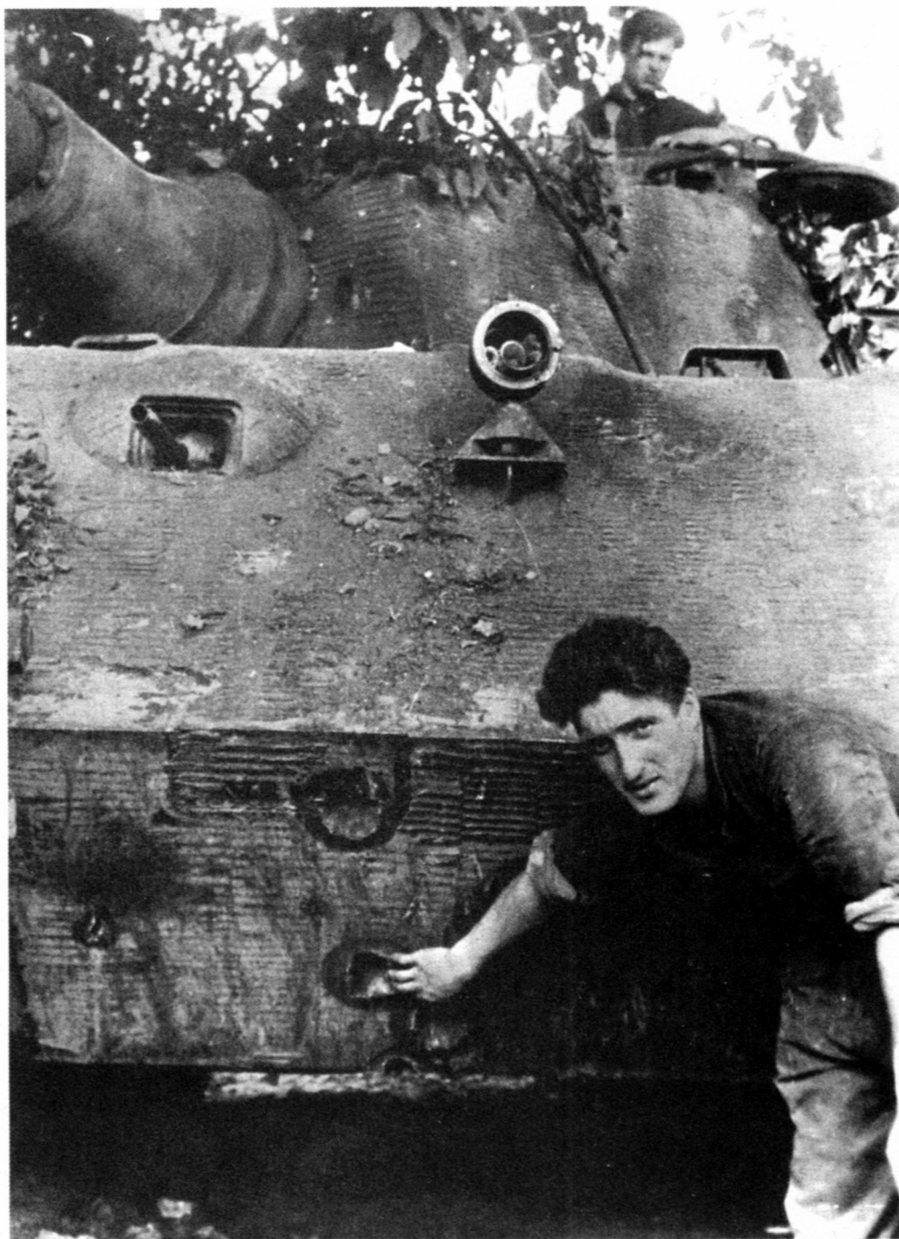
Немецкий танкист демонстрирует вмятины на нижнем лобовом листе корпуса «Королевского тигра». 75-мм английские и американские снаряды не причинили этому танку никакого вреда
