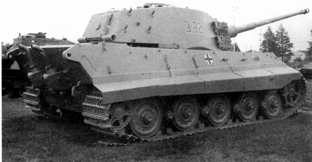
«Королевский тигр» в экспозиции военного музея на Абердинском полигоне. На фотографиях видно, что вместо срезанных листов брони приварены листы простой листовой стали. Снимки сделан в конце 1980-х годов
