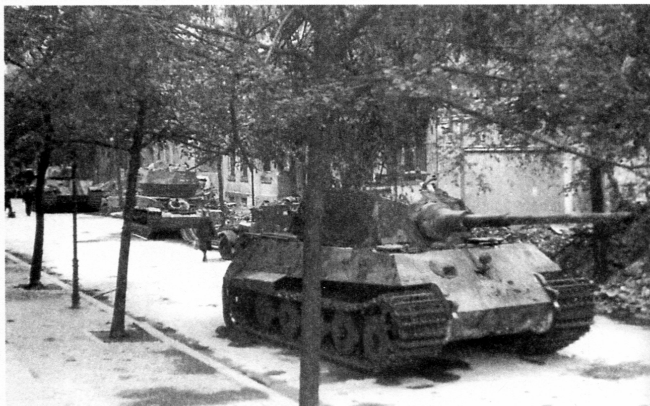
«Королевский тигр» подбитый на подступах к Берлину. По-видимому, в ходе ремонта на этой машине была установлена «пантеровская» 75-мм пушка KwK 42 (вверху)! Еще долго после окончания боев Берлин представлял собой кладбище боевой техники. На этой берлинской улице находятся «Королевский тигр», ЗСУ «Вирбельвинд» и «Пантера». 1945 год (внизу)
