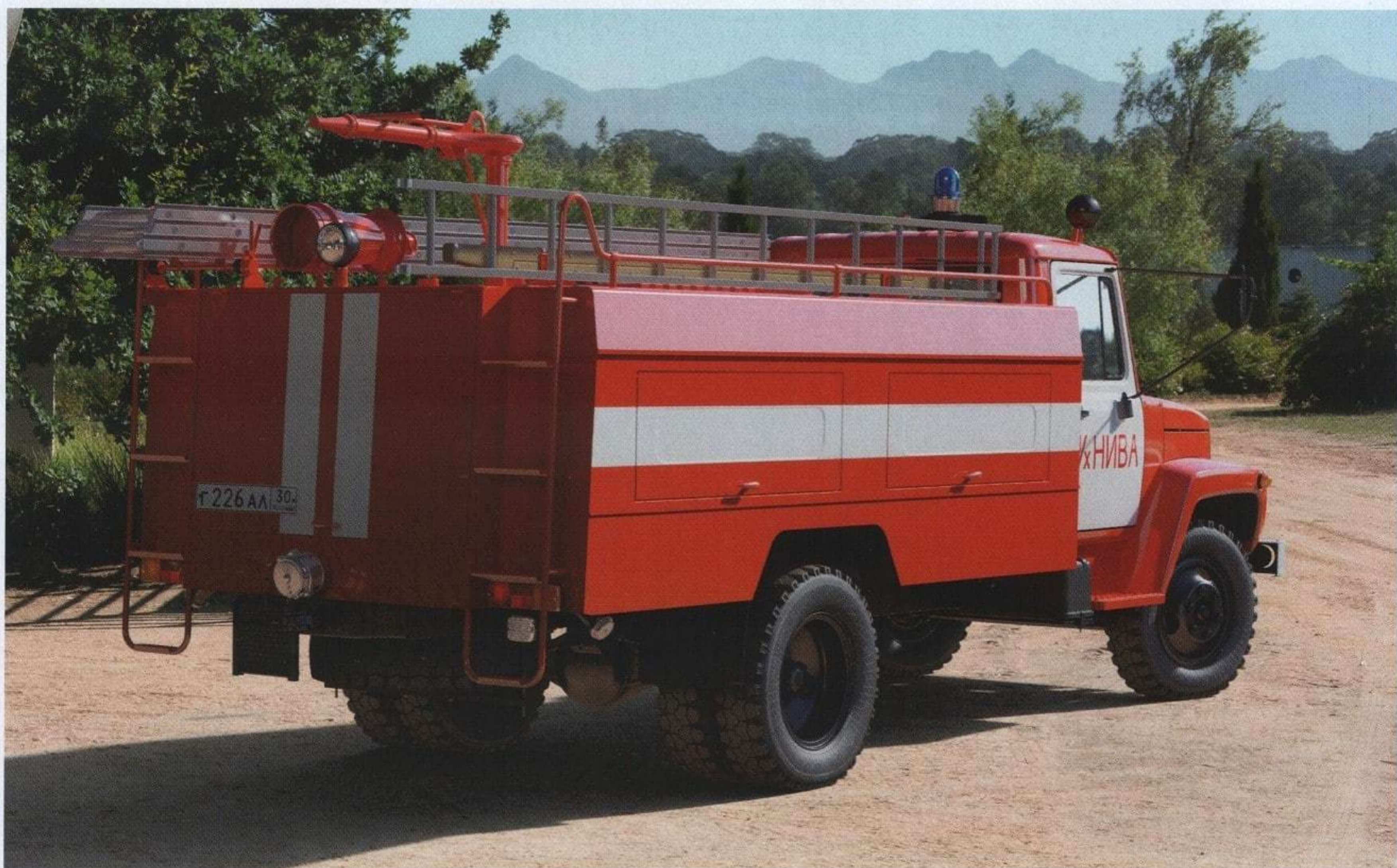
От предыдущих моделей АЦ-30(3307)-226 отличалась наличием штатного лафетного ствола
