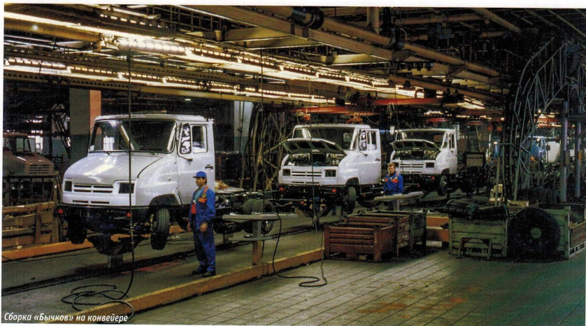
Сборка «Бычков» на конвейере
