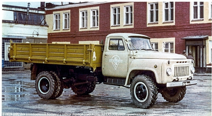
В 1974 году для изготовления боковых и задних бортов самосвала ГАЗ-САЗ-53Б стали применяться зигзагообразные профили
