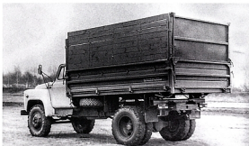
Саранский ГАЗ-СА3-3507 ходячий выпуск с продольной средней обвязкой основных бортов и увеличенными надбортными бортами (емкость платформы до 10 м³)
