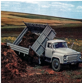
GAZ-CA3-536 стал первым советским серийным самосвалом с трехсторонней разгрузкой
