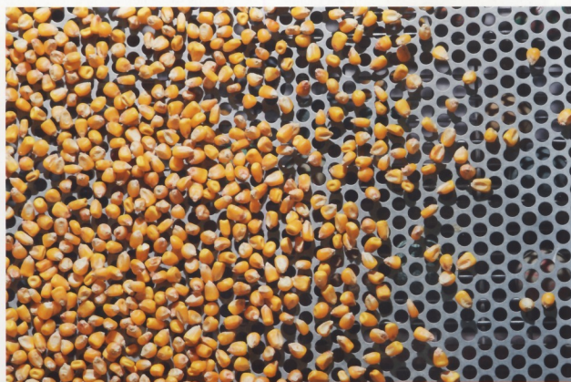
Простейшая очистка зерна происходит на вибрирующих решетках.
